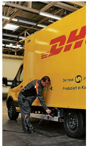
StreetScooter der DHL an einer Ladestation FOTO: DHL
